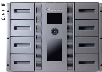
Quelle: HP Im Zusammenspiel mit einer Tape Library ermöglicht das LTFS-Format den Aufbau einer hierarchischen Verzeichnisstruktur, in der jeder Ordner ein Band symbolisiert.
