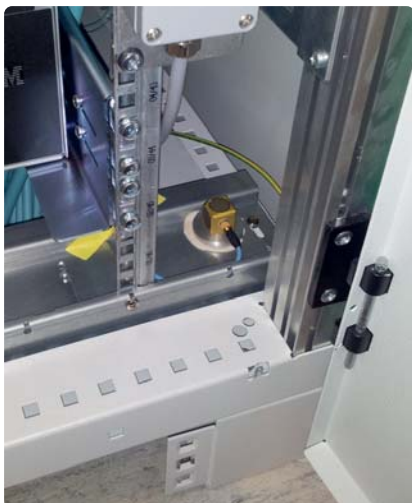
Links: Foto eines Sensors am Rack, Mitte: Foto eines Triggermesspunkts, rechts: Messanlage im Rack eingebaut
