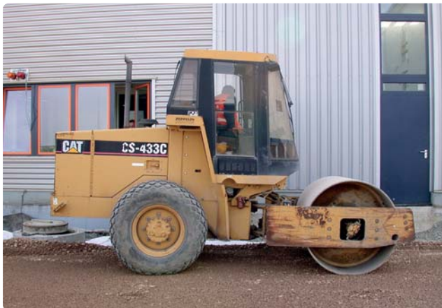
Links: Beispiel für erschütterungsintensive Bauarbeiten (Vibrationsverdichtung), rechts: Abbildung des eingebauten Warnlichts und des Signalhorns.
