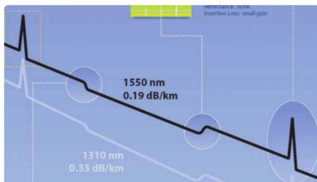
OTDR-Kurve: Die Dämpfung zeigt den Verlust zwischen zwei Orten auf der Faser.
