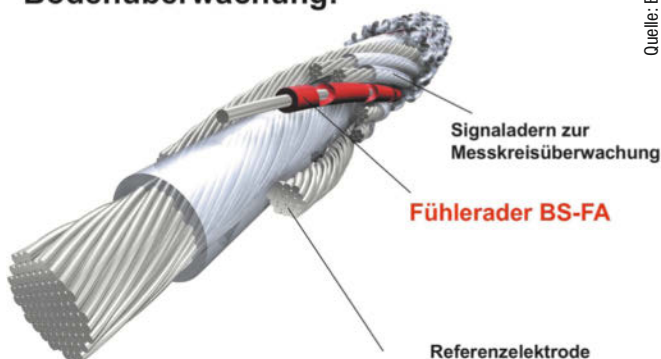
Aufbau eines Brandes-Rohrsensors
