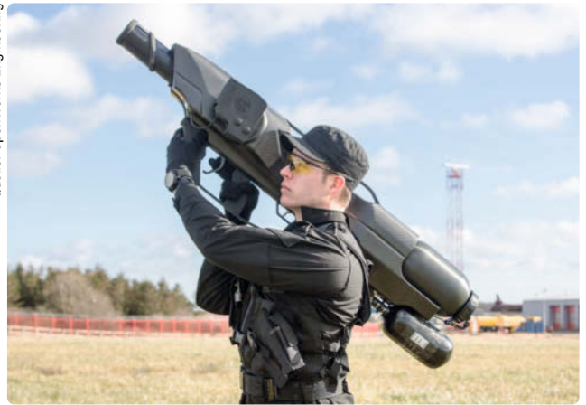
Das Skywall 100 von Open Works Engineering fängt Drohnen in einem Netz ab und lässt sie am Fallschirm zur Erde sinken.
