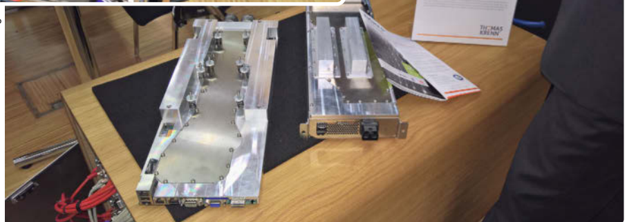
Servermodule von Thomas-Krenn mit aufmontiertem wasserführendem Kühlkörper.
