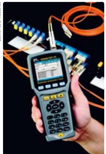
Bei Signaltek FO handelt es sich um einen Qualifizierungstester, mit dem Leistungsnachweise für Kupfer- wie auch Glasfasernetze erbracht werden können (Abb. 1).
