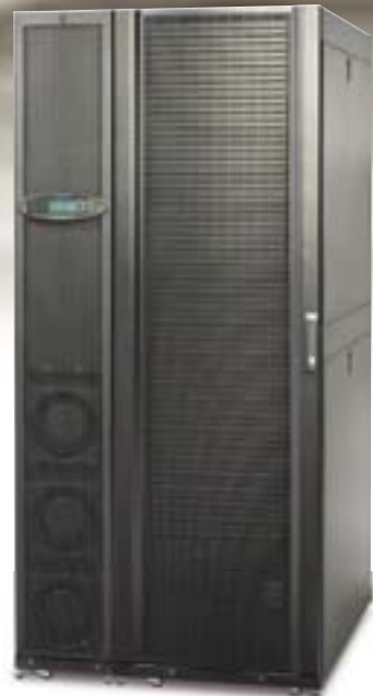
Die rack-basierte Kühlung von APC zieht warme Luft von der Wärmequelle auf der Rückseite und leitet kühle Luft zur Vorderseite, wo sie benachbarte Racks kühlt.
