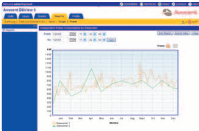
Die Avocent DSView 3-Steuerzentrale für KVM-Switches liefert detaillierte Reports zu den Stromverbräuchen von mehreren über IP ansteuerbaren Steckerleisten (Abb. 2).
